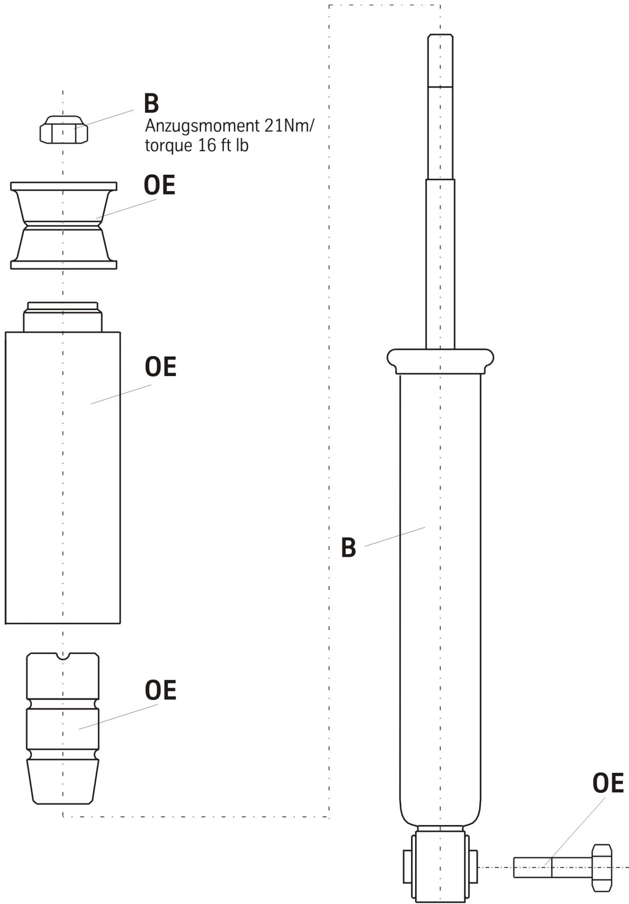
**Einbauanleitung für Hinterachs- Höhenverstellung**
